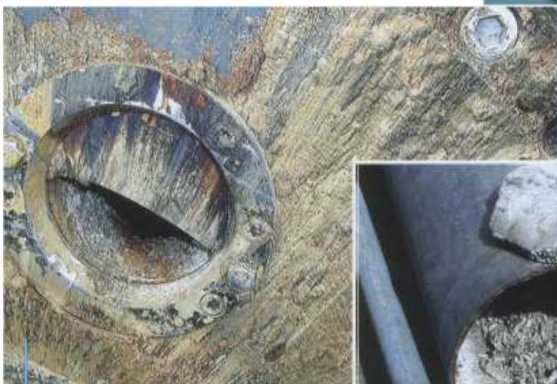
Отложение на задней стенке центрифуги
