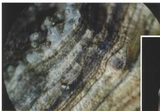
Струвит (магнийаммонийфосфат) в смеси с иловым/полимерным отложением
