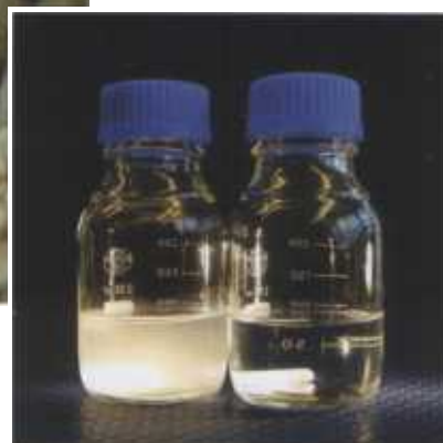
Струвит (магнийаммонийфосфат) в смеси с иловым/полимерным отложением
